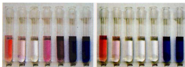
Abb. 4. Oben: Strukturänderung eines Anthocyans in wäßriger Lösung in Abhängigkeit vom pH-Wert (G = Zuckerrest). Unten links: Malvin in Wasser ( 5 \times 10^{-5} M) bei mehreren pH-Werten, unmittelbar nach dem Auflösen. Unten rechts: Malvin in Wasser ( 5 \times 10^{-5} M) bei mehreren pH-Werten, zwei Stunden nach dem Auflösen.
